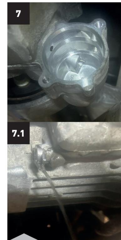
Nettoyer et rincer ensuite le boîtier de la pompe (figure 7) ou le boîtier du filtre à huile et le carter de l'embrayage Haldex (à l'intérieur) avec le nettoyant intérieur pour carter de boîte Pro-Line (N° de réf. 5188). Pulvériser à cet effet le nettoyant dans l'orifice de remplissage d'huile de l'embrayage Haldex jusqu'à ce qu'un liquide clair (figure 7.1) sorte au niveau de la vis de vidange d'huile. On peut ensuite encore souffler de l'air comprimé dans le carter Haldex (à l'intérieur).
