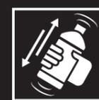
**Attention :** les huiles pour embrayages multidisques contiennent des additifs LS qui se déposent au fond lors du stockage. Il est donc impératif de bien agiter ces huiles avant leur utilisation afin d'obtenir un mélange homogène des additifs LS et de l'huile.
