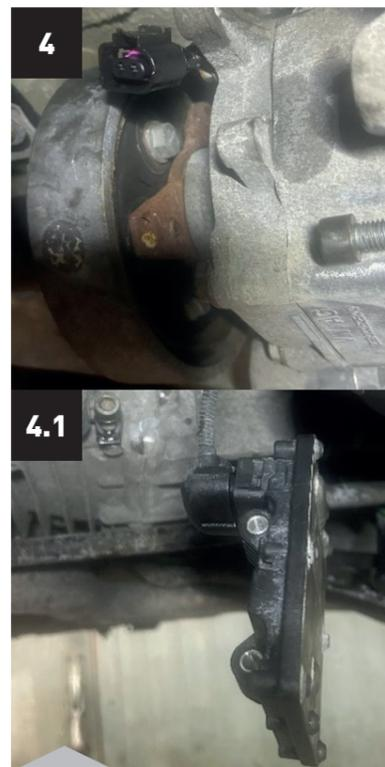
Débrancher la fiche de la pompe de précharge sur le calculateur. Il peut être utile de déposer le calculateur si un déverrouillage de la fiche est impossible dans l'état monté (figures 4 + 4.1).
