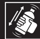
**Atención:** los aceites para embragues multidisco se mezclan con aditivos LS, que se sedimentan durante el almacenamiento. Por ello, es esencial agitar bien los aceites antes de utilizarlos para que los aditivos LS se mezclen homogéneamente con el aceite.
