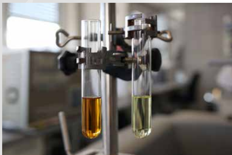
Alte Bremsflüssigkeit (links) im Vergleich zu neuer, unbenutzter Bremsflüssigkeit (rechts).
