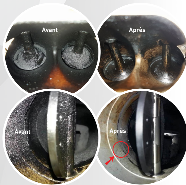
Gros plan des soupapes d'admission (en haut) et du clapet de la tubulure d'admission (en bas).
