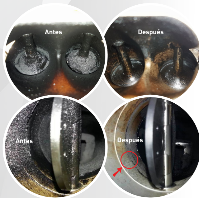
Primer plano de las válvulas de admisión (arriba) y de la compuerta del colector (abajo).
